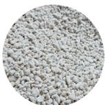
Die Rigidur Schall-dämm-schüttung ist für den Einsatz auf Holzbalkendecken zur besonderen Verbesserung des Schallschutzes durch Beschwerung der Deckenkonstruktion geeignet. Darüber hinaus werden Rohre und Kabel überdeckt und ein planebener Untergrund für den Rigidur Trockenestrich geschaffen.
