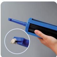
Halten Sie die Rigitone Fix Pistole etwas nach oben gerichtet und betätigen Sie solange den Abzug bis keine Luft mehr in der Kartusche vorhanden ist und das VARIO Fugenspachtelmaterial aus der Fugendüse ohne Unterbrechung austritt.
