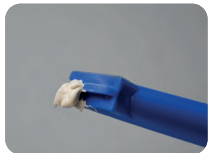
Die Rigitone Fix Pistole etwas hochhalten und solange den Abzug betätigen, bis keine Luft mehr in der Kartusche vorhanden ist und das VARIO Fugenspachtelmaterial aus der Fugendüse ohne Unterbrechung austritt.
