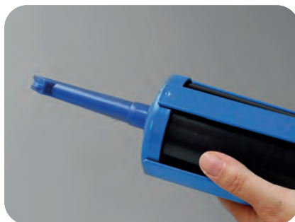
Die Rigitone Fix Pistole etwas hochhalten und solange den Abzug betätigen, bis keine Luft mehr in der Kartusche vorhanden ist und das VARIO Fugenspachtelmaterial aus der Fugendüse ohne Unterbrechung austritt.
