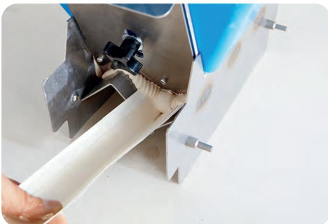
Der Rigips Levelline wird durch die Öffnung eingeschoben und gelangt über eine Führungsschiene zur rückseitigen Öffnung ...
