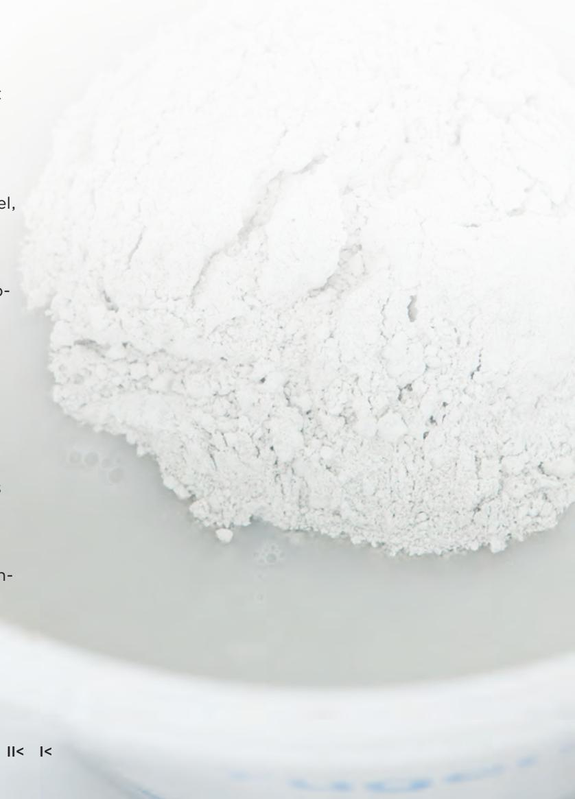
Der Hauptanteil dieses Wassers wird nicht zum Abbinden des Gipses benötigt, sondern trocknet aus der erhärteten Spachtelmasse aus. Überall dort, wo dieses Überschusswasser war, entstehen Poren. Da Spachtelmassen auf Basis von Beta-Gips viel mehr Überschusswasser enthalten als die auf Basis von Alpha-Gips, sind erhärtete und ausgetrocknete Beta-Fugenfüller deutlich poröser und damit weniger dicht als Spachtelmassen auf Alpha-Basis. Und weil porösere Materialien bei gleicher chemischer Zusammen-
