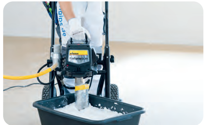
Airless Ansaugrohr in die Masse tauchen
