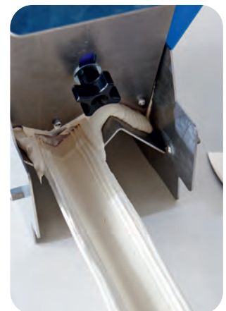
... wo die Spachtelauftragsmenge auf den Rigips Levelline reguliert werden kann.
