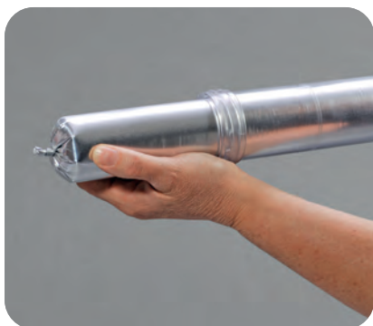
Den Schlauchbeutel mit dem Rigitone Mix in die Pistole einlegen und den Verschluss abschneiden.
