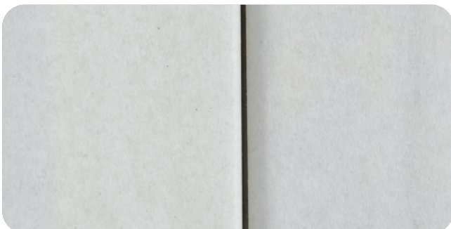
Obere Platte: gefaste Kante an Untere Platte: scharfe Schnittkante
