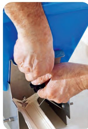
... wo die Spachtelauftragsmenge auf den Rigips Levelline reguliert werden kann.
