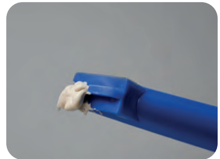
Die Rigitone Fix Pistole etwas hochhalten und solange den Abzug betätigen, bis keine Luft mehr in der Kartusche vorhanden ist und das VARIO Fugenspachtelmaterial aus der Fugendüse ohne Unterbrechung heraustritt.
