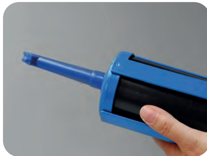
Die Rigitone Fix Pistole etwas hochhalten und solange den Abzug betätigen, bis keine Luft mehr in der Kartusche vorhanden ist und das VARIO Fugenspachtelmaterial aus der Fugendüse ohne Unterbrechung heraustritt.
