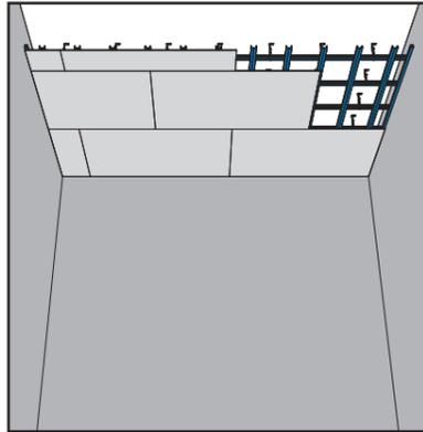
Decken mit Rigips Glasroc X sind grundsätzlich in der Querverlegung zu montieren.
