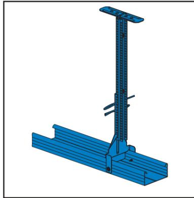
Um die auftretende Windlast aufnehmen zu können, sollten ab einer Einbauhöhe von > 400 mm die Nonius Oberteile Rücken an Rücken geschraubt werden. Dabei werden nach der Deckenmontage die jeweiligen Oberteile mit einer Bohrschraube in den Drittelpunkten der Abhängöhe miteinander verschraubt.
