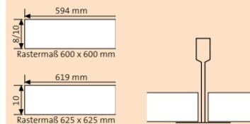
Die Kante A ermöglicht die Einlegemontage in das sichtbare Schienensystem T15/T24.
