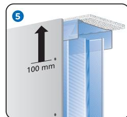
Verschraubung ca. 100 mm von der Decke (Fußboden)
