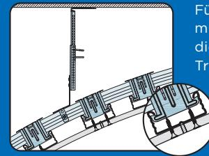
Für eine gleichmäßige Ausformung des Bogens empfehlen wir die Anordnung zusätzlicher Tragprofile an den Plattenenden.
