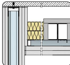
Wandanschluss an Trennwand mit Brandbeanspruchung aus dem Zwischendeckenbereich
