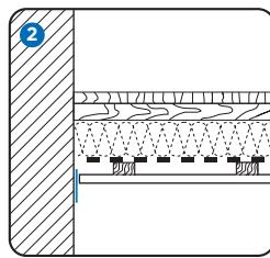
Anschluss an Giebelwände mit Rigips TrennFix
