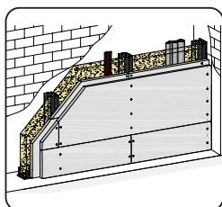
die 2. Lage mit TN 4,2 x 70 mm, im Abstand von ≤ 200 mm. Fugen einschl. umlaufende Anschlussfugen sind z. B. mit VARIO Fugenspachtel zu verspachteln. Weitere technische Angaben siehe Prüfzeugnis.
