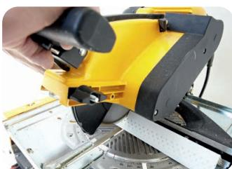
Sollen mehrere Profilleisten (AquaBead/AquaBead L-Trim) auf die gleiche Länge gebracht werden, schneiden Sie diese gleichzeitig mit der Kappsäge - das spart zusätzlich Zeit.
