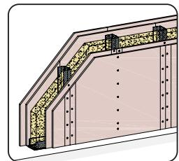
**Unterkonstruktion mit 312,5 mm****Achsabstand**
