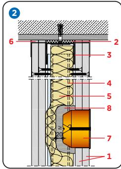
Einbau der Elektrodose in Montagewand mit Gipsbett (Rigips Detail MW12-D-ED-2)
