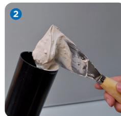
Den fertig (etwas dünner) angerührten VARIO Fugenspachtel zügig in die leicht schräg gestellte Kartusche einfüllen.
