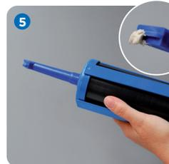
Halten Sie die Rigitone Fix Pistole etwas hoch und betätigen Sie solange den Abzug bis keine Luft mehr in der Kartusche vorhanden ist und das VARIO Fugenspachtelmaterial aus der Fugendüse ohne Unterbrechung heraustritt.
