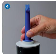
Die Rigitone Fix Fugendüse wird auf den Rigitone Fix Deckel aufgeschraubt. Anschließend das Kartuschenrohr in die Rigitone Fix Pistole einsetzen.
