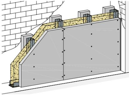
Schachtwände mit einfachem Ständerwerk 1-lagig beplankt
