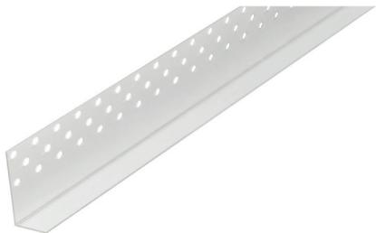
**Produktbeschreibung:** Rigips AquaBead L-Trim ist ein selbstklebendes Abschlussprofil. Er besteht aus einem papierummantelten Kunststoffkern, der an der langen Schenkelseite gleichmäßig perforiert ist. Der Kleber ist stärkebasiert und durch Einsprühen mit Wasser zu aktivieren.
