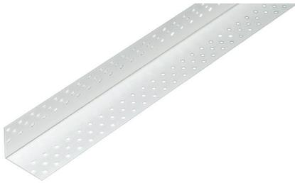
**Produktbeschreibung:** Rigips AquaBead ist ein selbstklebender Kantenschutz. Er besteht aus einem papierummantelten Kunststoffkern, der an den Schenkeln gleichmäßig perforiert ist. Der Kleber ist stärkebasiert und durch Einsprühen mit Wasser zu aktivieren.
