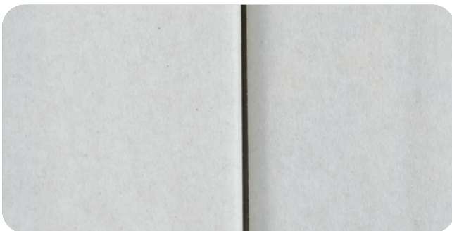
Obere Platte: gefaste Kante an Untere Platte: scharfe Schnittkante
