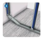
Das vertikale **C-Profil** wird dann gegen das anzuschließende Bauteil gedrückt und hochgeschoben ...
