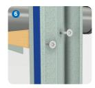
Wie oben, wird ein Ausschnitt in der Platte erzeugt. Falls nötig, wird ein Streifen von der Feder entfernt und die Platte von rechts nach links in die Nut eingefädelt.
