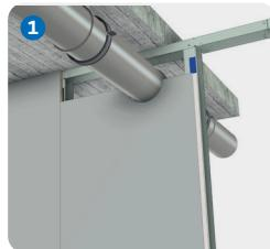
Damit die Feder der nachfolgenden Platte in die Nut der vorab montierten Platte gleiten kann, muss die Rohraussparung mit einem entsprechenden Abstand zum Rohr bemessen sein. Zum besseren Einfädeln kann ein Teil der Feder im oberen Bereich entfernt werden.
