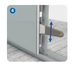
Die Platte kann nun vom Profil weggeklappt und von der angrenzenden Platte mit einem leichten Zug aus der Nut herausgelöst werden.
