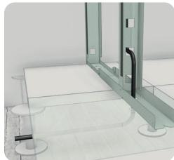
Kabel können oberhalb und unterhalb der vertikalen Profile verlaufen. Die maximale Höhe zwischen den horizontalen und vertikalen Pfosten beträgt 39 mm.
