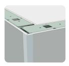
7um Schutz dieser Ecke wird nun eine Alu-Kantenschutzleiste auf die Ecke gesetzt. Die Leiste bleibt sichtbar, denn anzubringende Wanddekore enden an diesem Kantenschutz.
