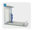
Das zweite Modul wird mit dem ersten gekoppelt. Die U-Profile der Module verfügen über "Laschen", um die Ausrichtung und Fixierung zu erleichtern.
