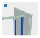
Die angrenzende Wand-Unterkonstruktion wird im gewünschten Winkel aufgestellt und das Rahmenprofil - C-Modul (blau) wird nun an die mit Platten ausgestattet Wandkonstruktion geschoben und fixiert.
