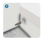
Die restlichen Platten werden mit einem geraden Spachtel gelöst. Dieser wird zwischen Platte und Modul eingeführt.
