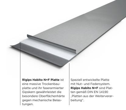
Die Rigips Habito N+F Platten sind auf einer Seite mit einer Nut und auf der gegenüberliegenden Seite mit einer Feder ausgestattet, die bei der Montage ineinander greifen und somit eine planebene Oberfläche entsteht.
