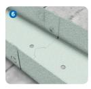
Dann wird der Schnellspanner geöffnet, das Modul auseinandergeschoben und die oberen horizontalen Profile zusammengeklickt.
