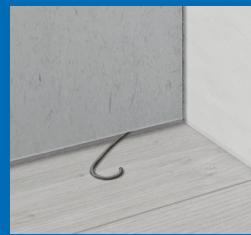
Die Einbringung des RigiRemover Drahtes ist nur auf einer Wandseite notwendig. Alle anderen Klettverbindungen können mit einem Standard-Schraubendreher gelöst werden. (Siehe Kapitel 4.1 „Rückbau der Wandkonstruktion RigiMove“)
