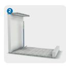
Durch die Öffnung des Schnellspanners lässt sich das vertikale RigiMove I-Modul auseinander schieben. Die Laschen der horizontalen Profilteile zeigen zur Bestandswand.
