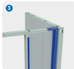
Die angrenzende Wandunterkonstruktion wird im gewünschten Winkel aufgestellt und das C-Modulprofil (blau) wird nun an die, mit Platten ausgestattete, Wandkonstruktion geschoben und fixiert. **3**
