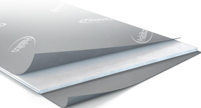
**RigiMove Systemplatte 12,5** ist eine massive Trockenbauplatte und ihr faserarmierter Gipskern gewährleistet die besondere Oberflächenhärte gegen mechanische Belastungen. Die speziell entwickelte Platte mit Nut- und Federsystem ermöglicht die schnelle Montage ohne Fugenverspachtelung. **RigiMove Systemplatten 12,5** sind „Platten aus der Weiterverarbeitung“ gemäß DIN EN 14190.
