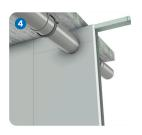
Auswechslungen können aus Holzquerschnitten oder UAProfilen mit Eckwinkeln erstellt werden.
