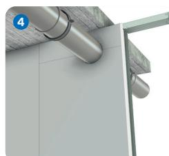
Der entstehende Spalt um das Rohr kann z. B. mit vorkomprimiertem Dichtungsband geschlossen werden.
