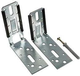
**Anwendungsbereich:** Zur Befestigung von Türpfostenprofilen aus Rigips CW 50- oder UA 50-Profilen an den Rohboden bzw. die Rohdecke. Zur Kabelführung befindet sich eine Öffnung in dem Winkel, der zur Anbindung an die Decke verwendet wird.
