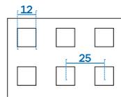
**Produktbeschreibung:** Lochgipsplatte nach DIN EN 14190 mit Premium-Luftreinigungseffekt Activ'Air und rückseitig kaschiertem Akustikvlies. Rigitone Platten weisen werkseitig angefasste und grundierte Kanten auf und sind somit sofort verarbeitungsfertig.
