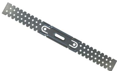
**Produktbeschreibung:** Aus feuerverzinktem Stahlband. Die Öffnungsweite des Abhängers von 60 mm ist auf das Rigips CD-Profil abgestimmt. Tragfähigkeitsklasse: 0,40 kN (40 kg)
