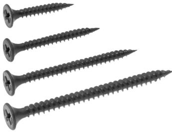
**Produktbeschreibung:** Typ TMN nach DIN EN 14566. Aus Stahl, spezialbehandelt, schwarz phosphatiert, nach DIN 18182-2, mit Trompetenkopf, ausgewalzter Spitze, Kreuzschlitz PH Gr. 2 und Doppelganggewinde.
