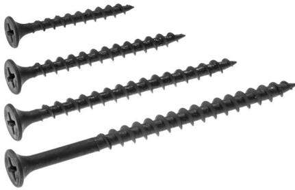
**Produktbeschreibung:** Typ THN nach DIN EN 14566. Aus Stahl, spezialbehandelt, schwarz phosphatiert, nach DIN 18182-2, mit Trompetenkopf, ausgewalzter Spitze, Kreuzschlitz PH Gr. 2 und Grobgewinde.
