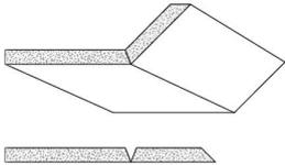
1 x V-Fräsung 45° / 1 x V-Fräsung 90°
