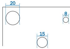
**Produktbeschreibung:** Lochgipsplatte nach DIN EN 14190 mit Premium-Luftreinigungseffekt Activ'Air und rückseitig kaschiertem Akustikvlies. Die angefasten und grundierten Spezialkanten werden auf Stoß verlegt. Diese Fugenausbildung ermöglicht eine sehr materialsparende Fugenverspachtelung.
