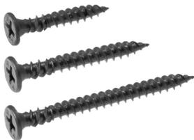
**Produktbeschreibung:** Typ UMN nach DIN EN 14566. Schnellbauschrauben phosphatiert mit Schneidringkopf, Nadelspitze und gegenläufigem Gewinde am Schraubenkopf.
