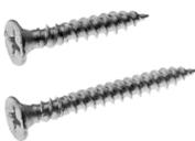
**Anwendungsbereich:** Die Rigips TITAN Schnellbauschraube TN dient zur Befestigung von Rigips Glasroc X auf Metallprofilen aus Stahlblech bis 0,7 mm Dicke.
