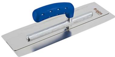
**Produktbeschreibung:** Glättekelle mit Doppelblatt-Technologie. Extra lange Aluminiumstütze und ergonomischer 2-Komponenten-Softgriff. Rostfreies Edelstahlblatt, 0,3 mm stark. Durch die abgeschrägten Seiten und die abgerundeten Ecken wird ein gratfreies Spachteln ermöglicht.
