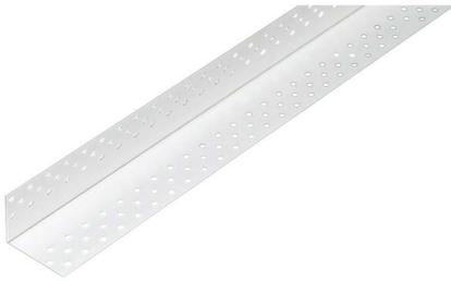
**Produktbeschreibung:** Rigips AquaBead ist ein selbstklebender Kantenschutz. Er besteht aus einem papierummantelten Kunststoffkern, der an den Schenkeln gleichmäßig perforiert ist. Der Kleber ist stärkebasiert und durch Einsprühen mit Wasser zu aktivieren.
