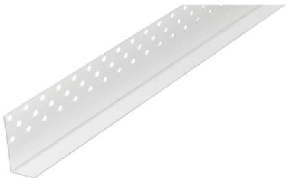
**Produktbeschreibung:** Rigips AquaBead L-Trim ist ein selbstklebendes Abschlussprofil. Er besteht aus einem papierummantelten Kunststoffkern, der an der langen Schenkelseite gleichmäßig perforiert ist. Der Kleber ist stärkebasiert und durch Einsprühen mit Wasser zu aktivieren.
