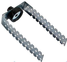
**Produktbeschreibung:** Aus verzinktem Stahlblech. Schallentkopplung durch Federdämpfung (frequenz- und lastabhängig) 16 dB i.M. Tragfähigkeitsklasse: 0,40 kN (40 kg)
