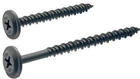
**Produktbeschreibung:** Typ WMN nach DIN EN 14566. Aus Stahl phosphatiert, nach DIN 18182-2, mit Flachkopf, Nadelspitze, Hi-Lo-Gewinde und Kreuzschlitz PH Gr. 2.
