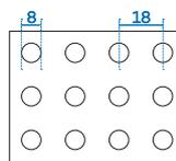
**Produktbeschreibung:** Graphitmodifizierte Lochgipsplatte nach DIN EN 14190 mit besonders hoher Wärmeleitfähigkeit = 0,52 W / (m·k) und rückseitig kaschiertem Akustikvlies. Rigitone Platten weisen werkseitig angefasste und grundierte Kanten auf und sind somit sofort verarbeitungsfertig.
