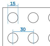
**Produktbeschreibung:** Lochgipsplatte nach DIN EN 14190 mit Premium-Luftreinigungseffekt Activ'Air und rückseitig kaschiertem Akustikvlies. Rigitone Platten weisen werkseitig angefasste und grundierte Kanten auf und sind somit sofort verarbeitungsfertig.
