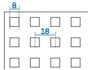
**Produktbeschreibung:** Lochgipsplatte nach DIN EN 14190 mit Premium-Luftreinigungseffekt Activ'Air und rückseitig kaschiertem Akustikvlies. Die angefasten und grundierten Spezialkanten werden auf Stoß verlegt. Diese Fugenausbildung ermöglicht eine sehr materialsparende Fugenverspachtelung.
