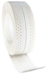
**Produktbeschreibung:** Rigips AquaBead Flex PRO ist ein flexibler und selbstklebender Kantenschutz. Er besteht aus einem papierummantelten Kunststoffkern, der an den Schenkeln gleichmäßig perforiert ist. Der Kleber ist stärkebasiert und durch Einsprühen mit Wasser zu aktivieren.
