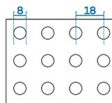
**Produktbeschreibung:** Lochgipsplatte nach DIN EN 14190 mit Premium-Luftreinigungseffekt Activ'Air und rückseitig kaschiertem Akustikvlies. Rigitone Platten weisen werkseitig angefaste und grundierte Kanten auf und sind somit sofort verarbeitungsfertig.
