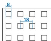
**Produktbeschreibung:** Lochgipsplatte nach DIN EN 14190 mit Premium-Luftreinigungseffekt Activ'Air und rückseitig kaschiertem Akustikvlies. Rigitone Platten weisen werkseitig angefasste und grundierte Kanten auf und sind somit sofort verarbeitungsfertig.
