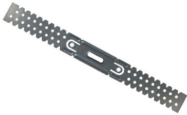
**Produktbeschreibung:** Aus feuerverzinktem Stahlband. Die Öffnungsweite des Abhängers von 60 mm ist auf das Rigips CD-Profil abgestimmt.
