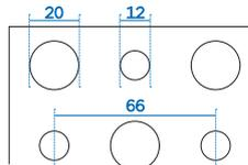
**Produktbeschreibung:** Lochgipsplatte nach DIN EN 14190 mit Premium-Luftreinigungseffekt Activ'Air und rückseitig kaschiertem Akustikvlies. Rigitone Platten weisen werkseitig angefasste und grundierte Kanten auf und sind somit sofort verarbeitungsfertig.
