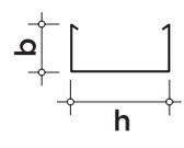
**Produktbeschreibung:** Profil nach DIN 18182-1 / DIN EN 14195 aus Stahlblech nach DIN EN 10346. Materialtoleranzen nach DIN EN 10143.
