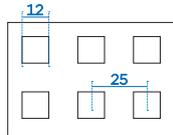
**Produktbeschreibung:** Graphitmodifizierte Lochgipsplatte nach DIN EN 14190 mit besonders hoher Wärmeleitfähigkeit = 0,52 W / (m·k) und rückseitig kaschiertem Akustikvlies. Rigitone Platten weisen werkseitig angefasste und grundierte Kanten auf und sind somit sofort verarbeitungsfertig.
