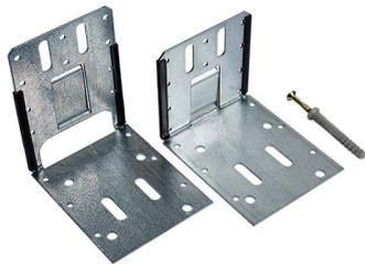
**Anwendungsbereich:** Zur Befestigung von Türpfostenprofilen aus Rigips CW 100- oder UA 100-Profilen an den Rohboden bzw. die Rohdecke. Zur Kabelführung befindet sich eine Öffnung in dem Winkel, der zur Anbindung an die Decke verwendet wird.
