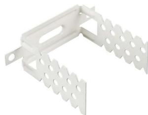
**Produktbeschreibung:** Aus feuerverzinktem Stahlband. Korrosionskategorie C3-hoch nach DIN EN ISO 12944. Tragfähigkeitsklasse: 0,40 kN (40 kg)
