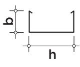
**Produktbeschreibung:** Profil nach DIN 18182-1/ DIN EN 14195 aus Stahlblech nach DIN EN 10346. Materialtoleranzen nach DIN EN 10143.
