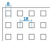
**Produktbeschreibung:** Graphitmodifizierte Lochgipsplatte nach DIN EN 14190 mit besonders hoher Wärmeleitfähigkeit = 0,52 W / (m·k) und rückseitig kaschiertem Akustikvlies. Rigitone Platten weisen werkseitig angefasste und grundierte Kanten auf und sind somit sofort verarbeitungsfertig.
