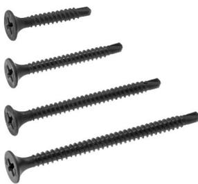
**Produktbeschreibung:** Typ TMD nach DIN EN 14566. Aus Stahl, spezialbehandelt, schwarz phosphatiert, nach DIN 18182-2, mit Trompetenkopf, Bohrspitze, Kreuzschlitz PH Gr. 2.
