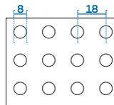
**Produktbeschreibung:** Lochgipsplatte nach DIN EN 14190 mit Premium-Luftreinigungseffekt Activ'Air und rückseitig kaschiertem Akustikvlies. Die angefasten und grundierten Spezialkanten werden auf Stoß verlegt. Diese Fugenausbildung ermöglicht eine sehr materialsparende Fugenverspachtelung.
