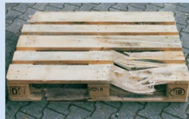
Mehr als 3 Bauteile defekt
