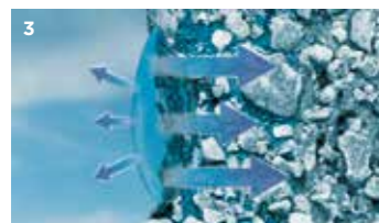
3: Putzoberflächen mit AquaBalance Technologie dehnen die Wassertropfen und vergrößern so die Verdunstungsfläche. Überschüssige Feuchtigkeit wird vorübergehend in die Kapillaren aufgenommen.
