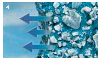
4: Bei sinkender Luftfeuchtigkeit wird die Feuchtigkeit sofort wieder in die Atmosphäre abgegeben. Die Fassade trocknet deutlich schneller und bietet Algen und Pilzen keinen Nährboden.
