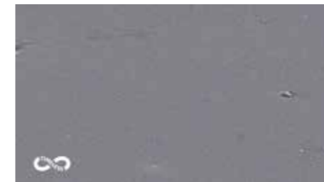
Vergrößerung des Duschkabinenglases SGG TIMELESS® nach täglicher Benutzung: Es sind keine rauen, weißlichen Stellen zu erkennen.
