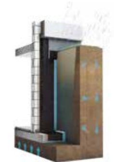
Wassereinwirkungsklasse: W2.1-E nach DIN 18533 Mäßige Einwirkung von drückendem Wasser - Situation: aufstauendes Wasser ohne Dränung
