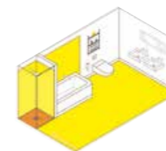
5 Häusliches Bad mit Badewanne ohne Brause und mit bodengleicher Dusche mit Duschartrennung
