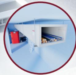
**4 Installationskanal mit festem Deckel**
