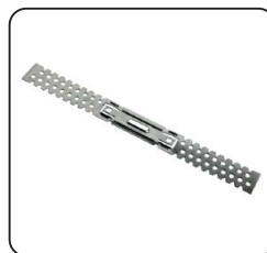
Rigips U-Direktabhänger Rigips CD-Deckenprofile werden über Direktabhänger an der Rohdecke / Dachschräge befestigt
