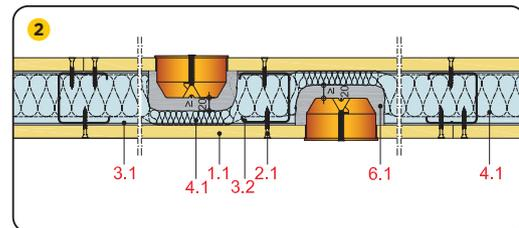
Einbau der Elektrodose in Montagewand mit Gipsbett
