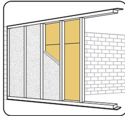
**9.14 Wandsysteme: Holz-Doppelständerwände****Holz-Unterkonstruktion**
