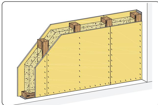
Die Holz-Unterkonstruktion besteht aus Holz der Sortierklasse S10 nach DIN 4074, Restfeuchte  $\leq 20\%$ .
