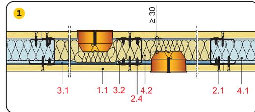
Einbau der Elektrodose in Montagewand mit gestauchter Mineralwolle für F 30, Schmelzpunkt  $\geq 1.000 \text{ }^\circ\text{C}$
