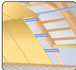
Metallprofile zuschneiden – mit Blechscher, Schlagschere oder Knabberer, niemals mit Trennschleifer/Flex, da sonst der Korrosionsschutz durch Verbrennung zerstört würde.
