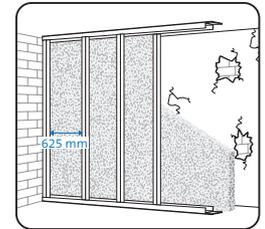
Anordnung der Unterkonstruktion
