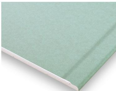
**Produktbeschreibung:** Kartonummantelte Gipsplatte nach DIN EN 520, Typ DFH2, kernimprägniert, verzögerte Wasser- aufnahme, faserarmierter Gipskern und geschlossene Oberfläche.
