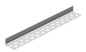
Rigips Abschlussprofile 13/25 dienen zur Herstellung von einseitig eingespachtelten Abschlüssen in Gipsplattensystemen. Das Profil ist auch unter der Bezeichnung 'Göppinger Profil' bekannt. Ein Schenkel des Profils weist eine Lochung auf, damit das Profil besonders sicher in Rigips Spachtelmassen eingebettet werden kann.
