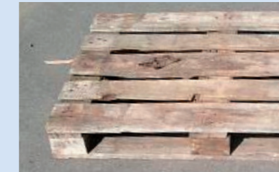
Es sind auf jeder Seite nicht mindestens ein Zeichen einer Bahn, ein Zeichen „EUR“, „UIC“ oder „EPAL“ auf einem Eck-Klotz vorhanden
