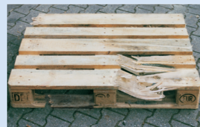
Mehr als 3 Bauteile defekt
