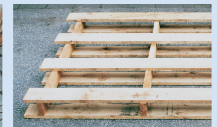
Offensichtlich abweichende Brett- oder Kantholzstärken
