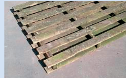
Nicht ausreichende Tragfähigkeit (morsches, faules, sprödes Holz, fehlende Nagelfestigkeit)
