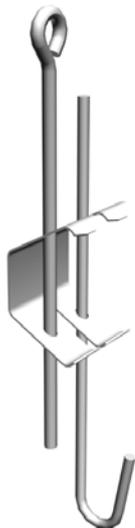
Rigips Schnellspannhänger, Haken/Öse dienen zur Ausbildung von Abhängungen in Gipsplattensystemen im Deckenbereich. Die Feder erlaubt eine Einstellung der Abhängehöhe. Rigips Schnellspannhänger mit Haken und Öse sind für Spannbereiche von 10 - 30 cm, 30 - 60 cm, 60 - 100 cm und 100 - 125 cm verfügbar.
