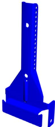
Rigips Nonius Unterteile CD 400 C5M – hoch dienen zur Ausbildung von Abhängungen in Gipsplattensystemen im Deckenbereich von Feucht- und Nassräumen. Das Rigips Nonius Unterteil wird mit dem Nonius Oberteil durch zwei Rigips Nonius Sicherungsklammern verbunden. Das Nonius Unterteil CD 400 C5M – hoch ermöglicht die Aufnahme des Rigips C-Deckenprofils als Grundprofil der Deckenkonstruktion und benötigt eine Verschraubung mit der Rigips Spezial-Bauschraube 3,5 x 10 mm.
