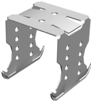
Rigips Kreuzschnellverbinder für UA 50 dienen zur Ausbildung von Kreuzverbindungen in höhenversetzten Deckenunterkonstruktion, in denen das Grundprofil durch ein Rigips UA Profil 50 gebildet wird. Hierbei wird mit Hilfe des Kreuzschnellverbinders das Rigips C-Deckenprofil als Tragprofil an das Grundprofil (UA 50) befestigt. Rigips Kreuzschnellverbinder bestehen als Formteil aus feuerverzinktem Stahlband.
