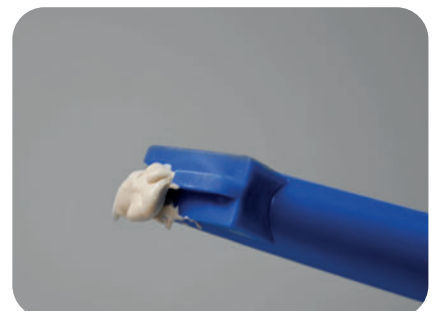
Die Rigitone Fix Pistole etwas hochhalten und solange den Abzug betätigen, bis keine Luft mehr in der Kartusche vorhanden ist und das VARIO Fugenspachtelmaterial aus der Fugendüse ohne Unterbrechung heraustritt.
