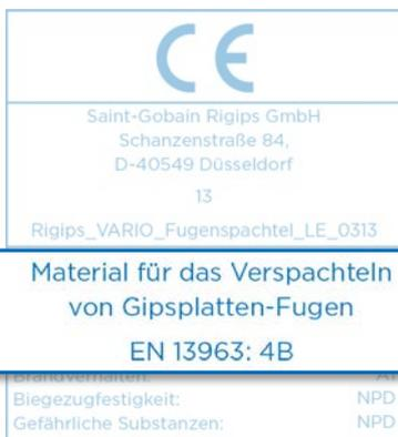
Anhand dieser Angabe ist erkennbar, dass es sich beim **VARIO Fugenspachtel** um einen Fugenspachtel gem. **DIN EN 13963 Typ 4B** handelt, der auf den dafür geeigneten Kanten ohne Bewehrungsstreifen verarbeitet werden darf und somit über eine sehr hohe Fugenfestigkeit verfügt.
