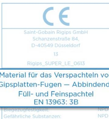
Anhand dieser Angabe ist erkennbar, dass es sich beim **SUPER Fugenfüller** um einen Füll- und Feinspachtel gem. **DIN EN 13963 Typ 3B** handelt, der seine ausreichende Fugenfestigkeit nur in Verbindung mit einem Bewehrungsstreifen erreicht.
