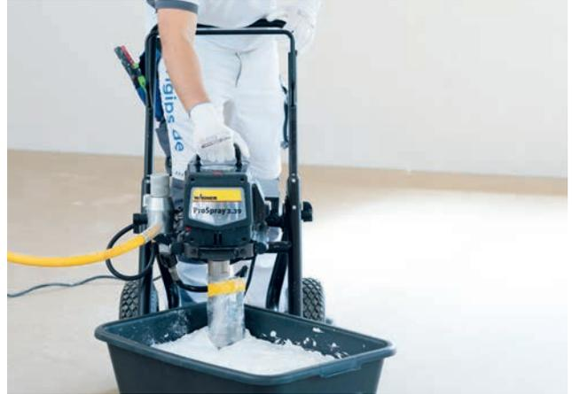
Airless Ansaugrohr in die Masse tauchen
