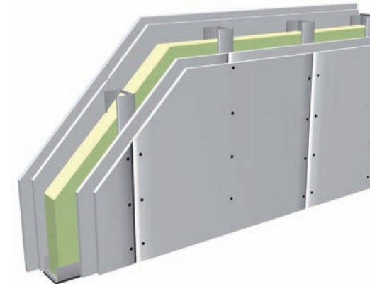
Rigips-Einfachständerwand doppelt beplankt
