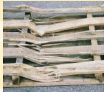
Mehr als 4 Bretter defekt
