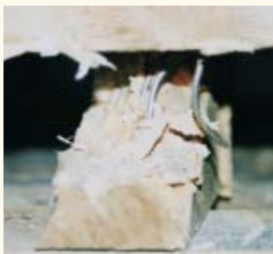
Kantholz so gesplittert, dass keine Nagelfestigkeit gegeben ist
