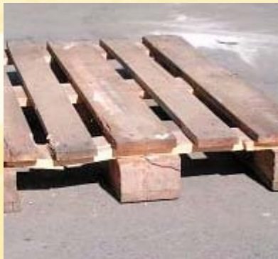
Querbrett gebrochen oder so beschädigt, dass mehr als 1 Nagel sichtbar ist (Querbrett = 80 cm; schmale Seite)
