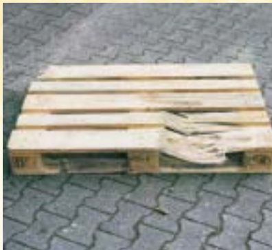
Mehr als 4 Bauteile defekt
