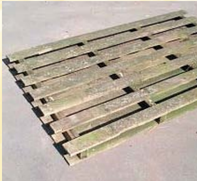
Nicht ausreichende Tragfähigkeit (morsches, faules, sprödes Holz, fehlende Nagelfestigkeit)
