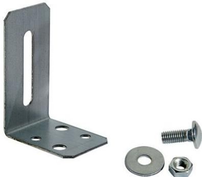
Mit Hilfe des Rigips Montagesatzes UA 50 werden Verbindungen und Anschlüsse von U-Aussteifungsprofilen 50/40-2 einfach hergestellt. Der Rigips Montagesatz für UA 50 besteht jeweils aus 4 Stück Anschlusswinkeln, Zargenschrauben M8, Sechskantmutter M8 und zugehörigen Unterlegscheiben der Öffnungsweite 8,5 mm. Die Abmessungen des Winkels sind auf das Rigips U-Aussteifungsprofil 50/40-2 abgestimmt.
