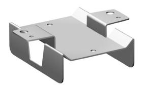
Rigips Direktbefestiger dienen zur direkten Befestigung von CD-Profilen im Deckenbereich und sind auch unter dem Begriff Schienenläufer bekannt. Die Geometrie des Abhängers ist ideal auf das Rigips C-Deckenprofil abgestimmt. Die Montage an der Rohdecke erfolgt über die Bohrungen an den Laschen des Befestigers. Rigips Direktbefestiger für C-Deckenprofile (Schienenläufer) werden aus feuerverzinktem Stahlblech hergestellt.
