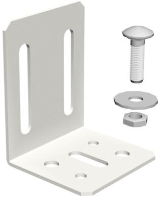
Mit Hilfe des Rigips Anschlusswinkelsets für UA 75, C3 - hoch werden Verbindungen und Anschlüsse von korrosionsschutzten U-Aussteifungsprofilen einfach hergestellt. Die Abmessungen des Winkels sind jeweils auf das Rigips U-Aussteifungsprofil 75/40/2 abgestimmt. Ein Set besteht aus 4 Winkeln und den zugehörigen Zargenschrauben.
