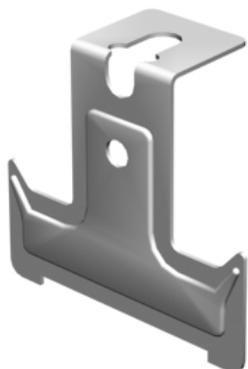
Rigips Ankerwinkel dienen zur Ausbildung von Kreuzverbindungen in abgehängten, höhenversetzten Deckenunterkonstruktion. Hierbei wird mit Hilfe von jeweils zwei Ankerwinkeln das Trag- an ein Grundprofil befestigt, wobei Grund- und Tragprofil aus Rigips Deckenprofilen CD 60/27 bestehen.
