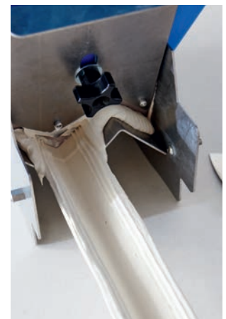
... wo die Spachtelauftragsmenge auf den Rigips Levelline reguliert werden kann.
