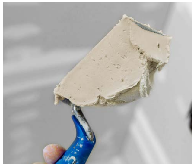
Die Konsistenz des angerührten Fugenspachtels sollte so sein, dass das Material von der umgedrehten Kelle nicht abrutscht (Kellentest).
