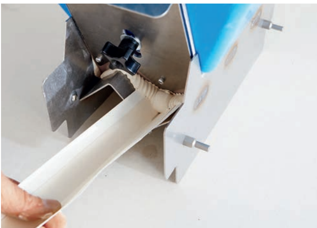
Der Rigips Levelline wird durch die Öffnung eingeschoben und gelangt über eine Führungsschiene zur rückseitigen Öffnung ...
